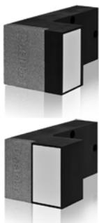
**Produktvorteile:** aus fäulnisbeständigem und FCKW-freiem PU-Hartschaumstoff (Polyurethan) • eingeschäumte Einlagen aus Stahl und Aluminium für kraftschlüssiges Verschrauben mit dem Untergrund • Aluplatte für die Verschraubung des Anbauteils • RF inkl. Befestigungsmaterial für Mauerwerk oder Beton erhältlich (bei RL optional)
