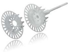
**Produktvorteile:** ermöglicht die vertiefte Montage nach EJOT STR-Prinzip für Mineralwollgedämmplatten mit geringer Querkzugfestigkeit • für homogene und glatte Oberflächen bei Dämmsystemen mit Mineralwollgedämmung • geringe Wärmebrückenwirkung (Chi-Wert 0,001 W/K) • Reduzierung von Dübelabzeichnungen • kein zusätzliches Setzwerkzeug erforderlich • dauerhafter Anpressdruck
