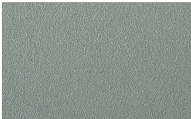
Rutschhemmende Industriebeschichtung (KLB 216) R 11 mit bito QS 422
